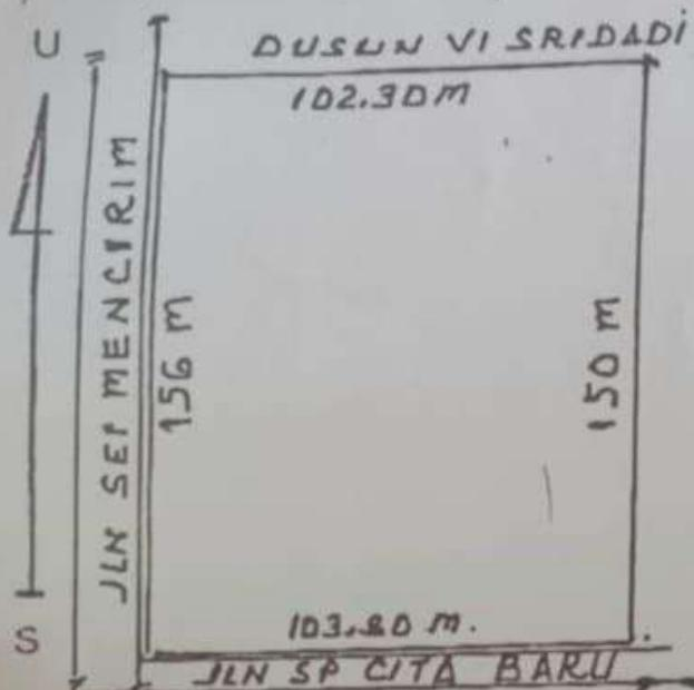
Setelah di adakan pengukuran selanjutnya di lanjutkan dengan pemasangan patok tanda tanda batas di setiap sudut dan tanda batas di maksud telah disetujui oleh yang menguasai/mengusahai tanah tersebut serta disetujui pula oleh masing-masing jiran batas sebagai saksi saksi.
